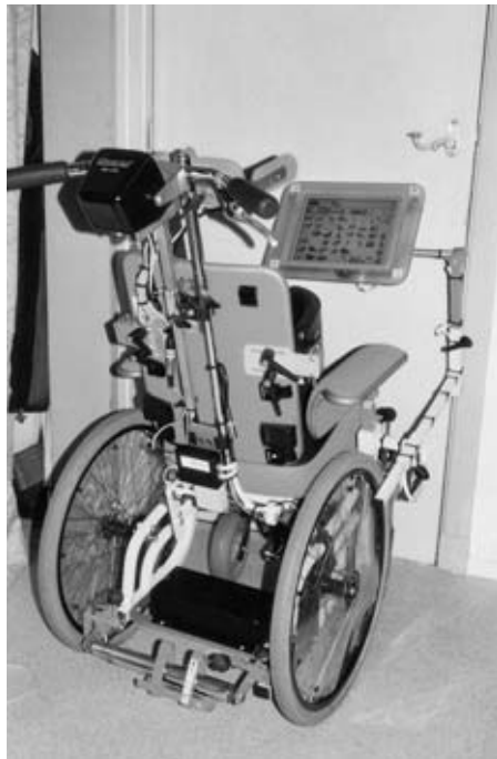
Fig. 3.10 Rolstoel met spraakcomputer. De gebruiker bedient de computer door met het hoofd tikjes tegen de hoofdsteun te geven.
